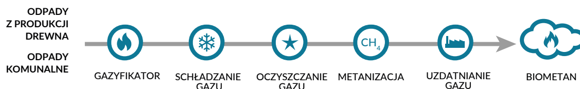
Rysunek 5. Schemat procesu gazyfikacji termicznej
